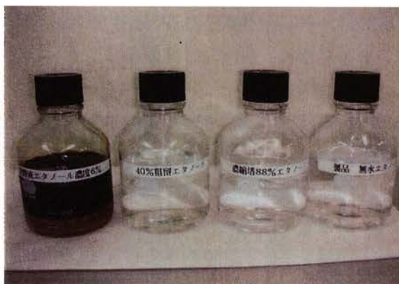
発酵もろみ液6% 粗留40% 濃縮88% 製品99.5Vol%
