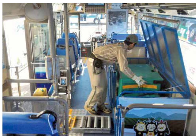
(上) 車両の一部を活用し荷台スペースを開発（サイズ：縦197cm×横80cm×高さ70cm）（下）バスへの積み込み状況
