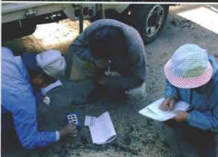
生ごみ堆肥の窒素、リン酸、カリ、pHなどの成分分析が分かっていることが望ましいため、実地研修でpH試験を行っているところ
