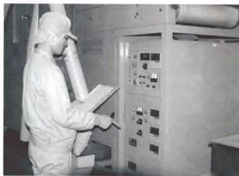
食用茶の殺菌にはマイクロ波乾燥火入機で茶温を105度以下にならないように維持することが必要。30分に一度、温度計で茶温を確認し記録する
