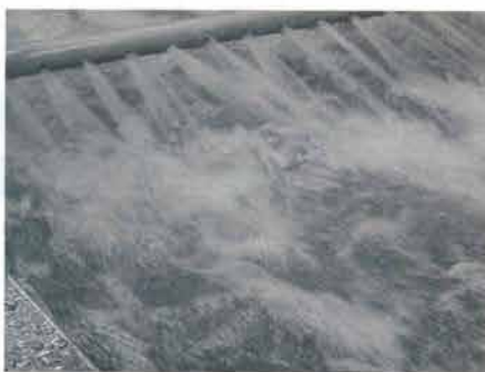
わさび茎の洗浄。シャワーと比重による洗浄で、この後、さらに洗浄する
