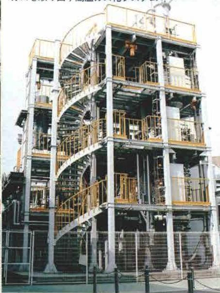
会場建設時に出た木材やペットボトルからバイオガスを取り出す高温ガス化システム
