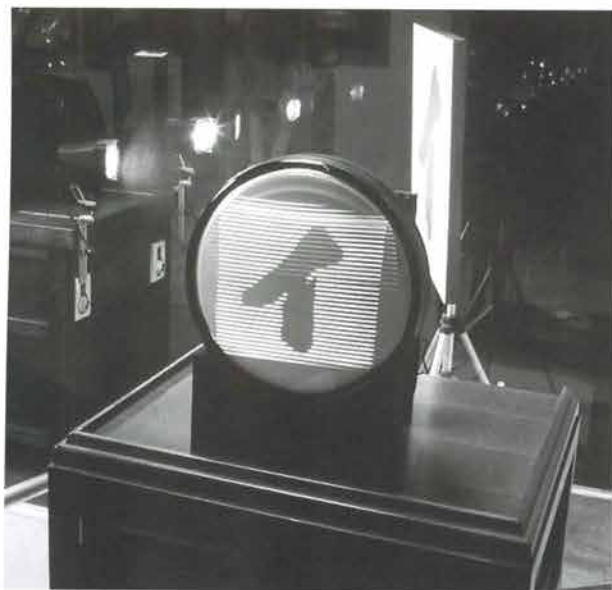
フォトンバレーの原点、高柳健次郎博士が世界で初めて電子式テレビで「イ」の字の送受信に成功（写真は再現装置によるもの）
