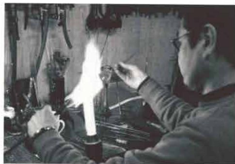
テクノマスター片山氏による理化学用ガラス機器の製造
