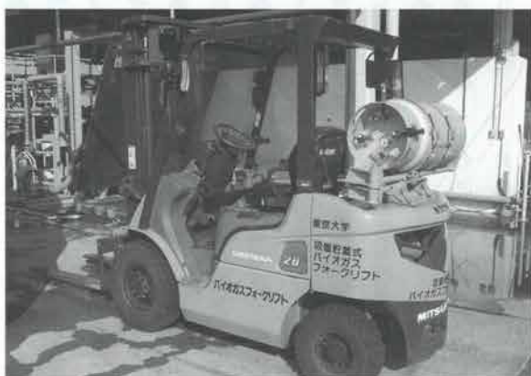
バイオガス由来メタンで走行・作業するフォークリフト
