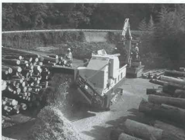
林地残材チップの製造
