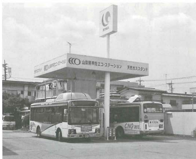
排出ガスのクリーン化をめざした天然ガス (CNG) バスと充填スタンド (山梨交通)
