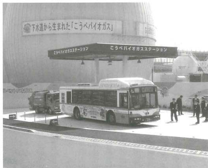
下水から出る汚泥を精製して作るバイオガスを使用してバスを走らせる (神戸市交通局)
