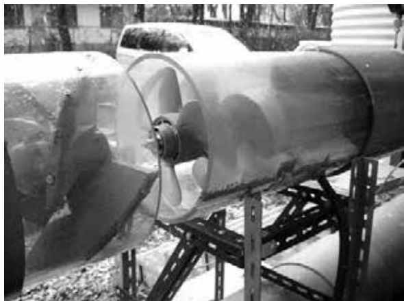
図1 プロペラを転用したマイクロ水力発電機 (内部が見えるように透明なパイプ内に設置した。手前が静翼、直列に配列したプロペラの後方に発電機本体が見える)
