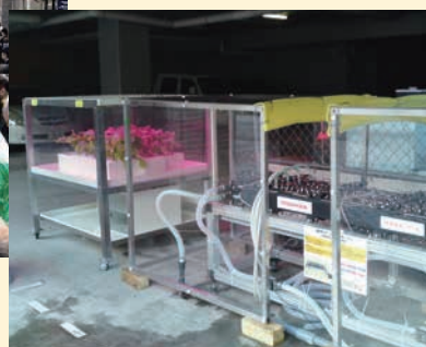
温度差発電による野菜栽培装置 ● 富山県黒部市 (p18-19)
