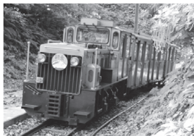
立山砂防工事専用軌道を走るトロッキ。工事関係者が利用する
