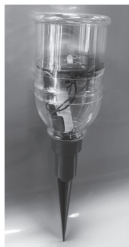
これ一つで発電・蓄電・発光の機能があるペットボトル。中央部に小さなLED電球がある
