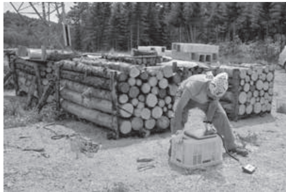
ボイラーに使う燃料丸太の乾燥試験。長さや積み方を変え、丸太の重さで含水率の変化を測る
