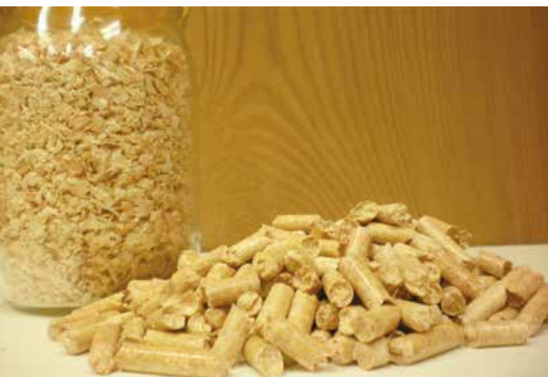
かなな屑（奥）と、それから作られたペレット（手前）。真庭市の銘建工業では良質なペレットが生産されている
