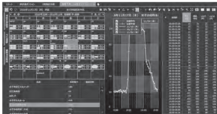
電力需要予測のパソコン画面（米子市役所本庁舎）
