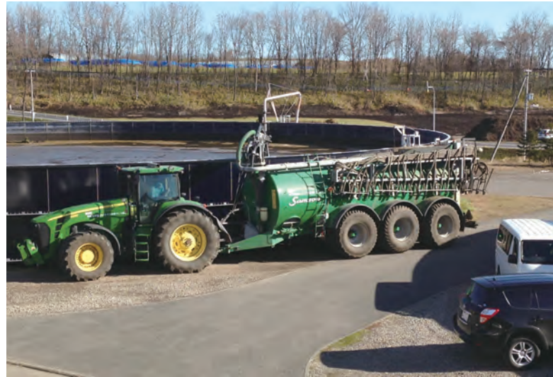
バイオガスプラントで家畜の排せつ物を処理してできた消化液を肥料として畑や牧草地に散布する散布車（北海道鹿追町）
