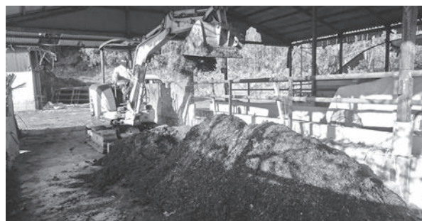
竹チップと鶏ふんを重機で混ぜて竹チップ堆肥を作成
