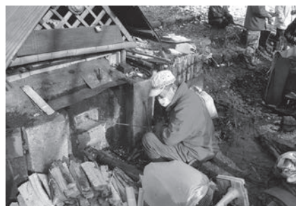
600*の炭材を詰め込んだ炭焼き窯に、薪をくべて炭を焼き上げる
