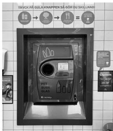
スーパーマーケットに設置されたデポジットシステムによる資源ゴミ回収機械
