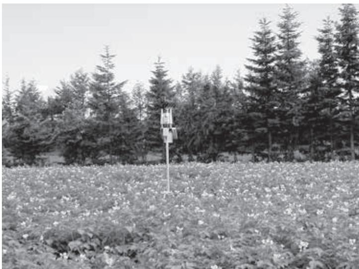
北海道のジャガイモ畑に設置されたウエザーバケット。センサーを備え、小型で軽量なため簡単に設置できる
