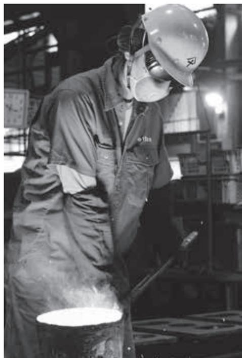
南部鉄器の製造工程の一つで、溶かした鉄を「生型」に入れる注湯作業の様子
