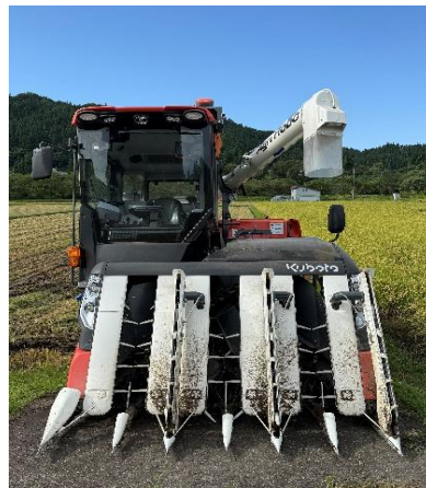
ロボット機能付きコンバイン
