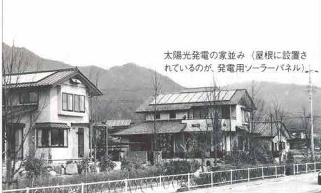
太陽光発電の家並み（屋根に設置されているのが、発電用ソーラーパネル）
