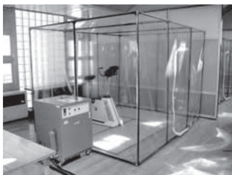
トレーニングセンターの低酸素室。標高 3500m のレベルまで酸素濃度を下げることが可能。低酸素環境でより強い負荷をかけたトレーニングができる
