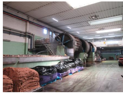
手前がタンニン槽、奥側にドラム 3 機
