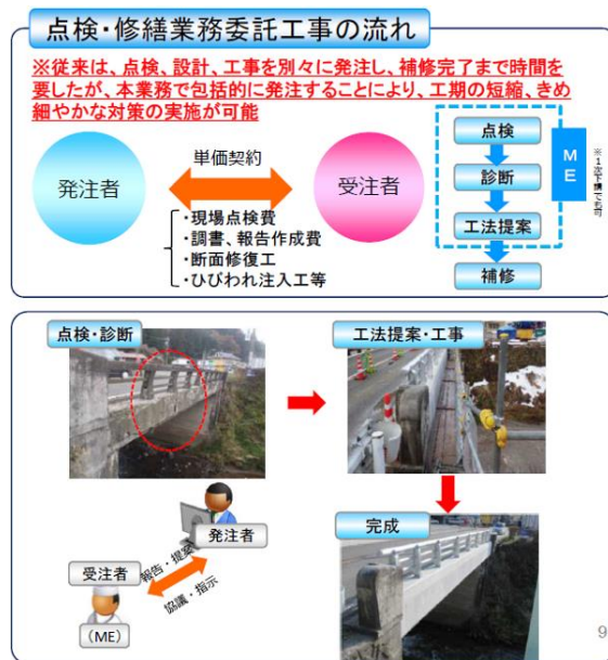
図5：点検・修繕業務委託工事の流れ 【出典：岐阜県ホームページ引用】
