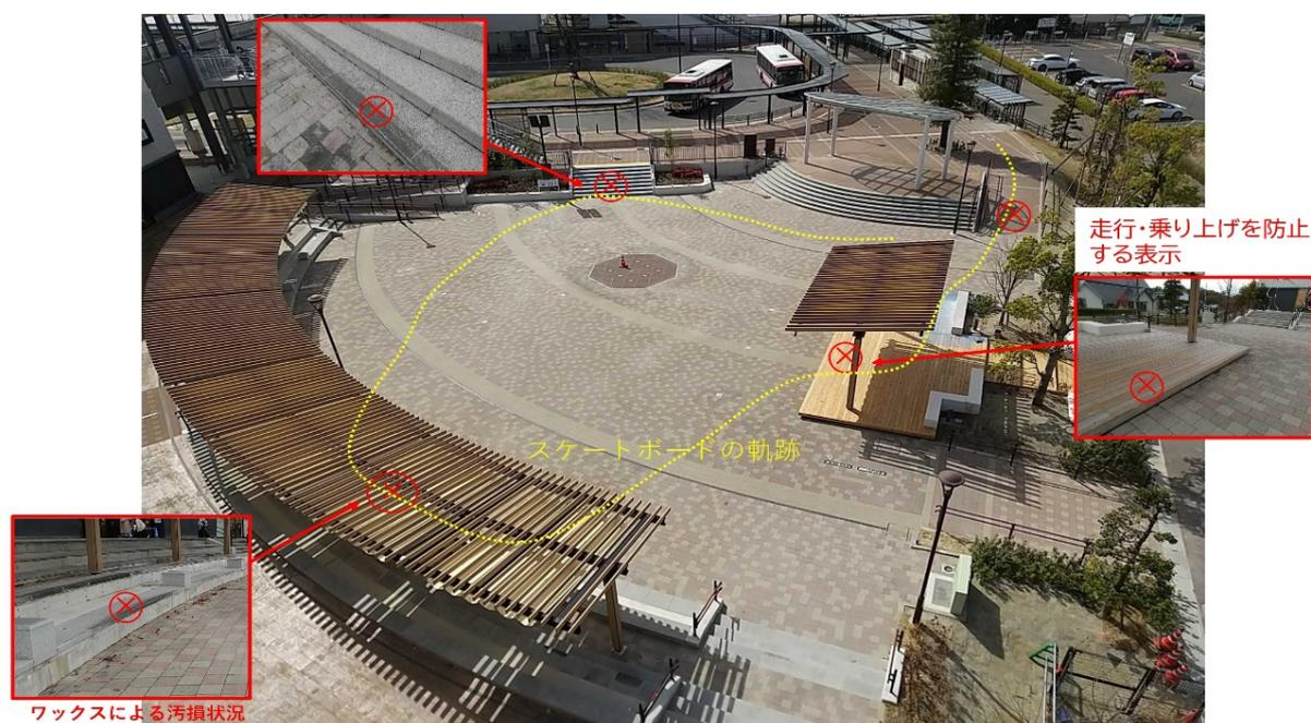
写真2 現場でのスケボー利用の被害状況
